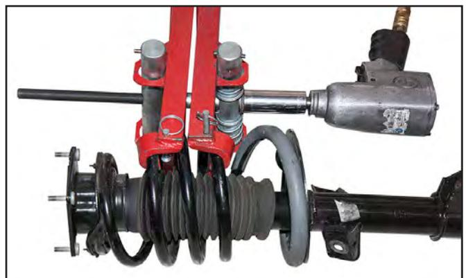
13. Remove strut shaft nut.
