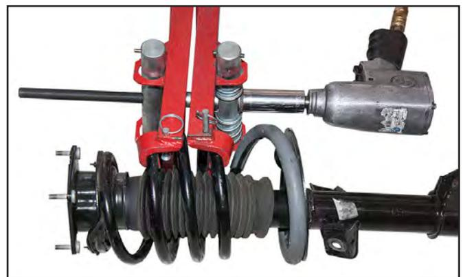
13. Remove strut shaft nut.
