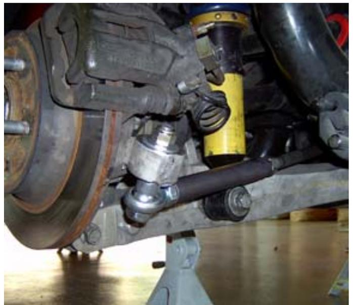
15. Slip the tie-rod end onto the stud.
